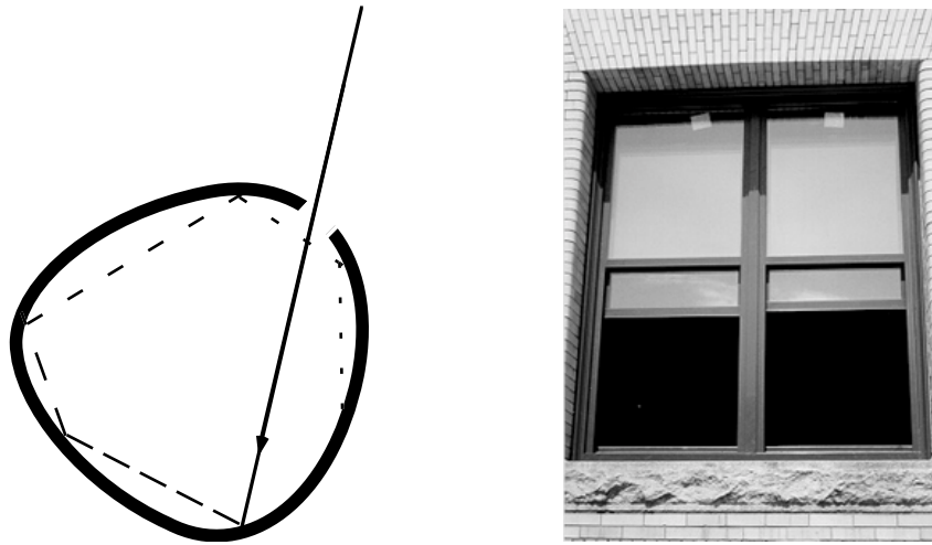
Fig. 88: Une cavité munie d'une petite fenêtre se comporte un peu comme un corps noir.
